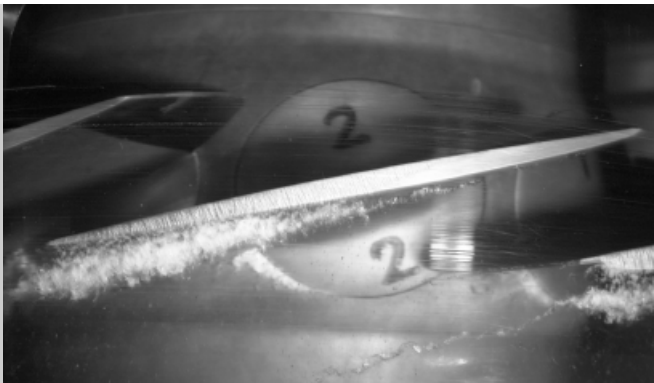
Pale sans collerette: la cavitation marginale colle à la pale et n'est de ce fait pas admissible
