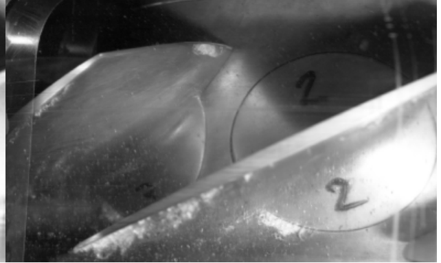
Cavitation de poche admissible après modification de l'arrêt d'entrée de la pale
