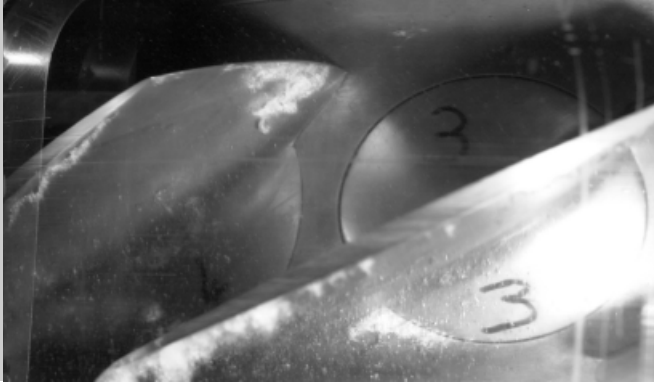
Cavitation de poche non admissible avant modification de l'arrêt d'entrée de la pale
