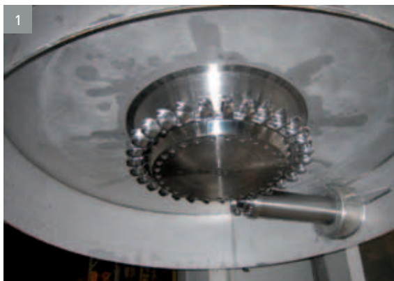
1 La Curala, Le Châble, CH, 50 l/s, 592 m, 240 kW, turbine Pelton à un injecteur sur l'eau potable, Mhylab, Gasa SA, 2010 (© SIB)
