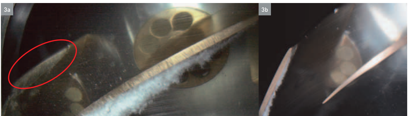
3 Illustration de l'amélioration du comportement en cavitation durant la phase de développement au point de rendement maximum pour un coefficient de cavitation donné : 3a configuration initiale faisant apparaître une large poche de cavitation sous le bord d'attaque de la pale (entourée en rouge) et une importante cavitation marginale et de jeu à l'extrémité de la pale, jugées non admissibles ;
