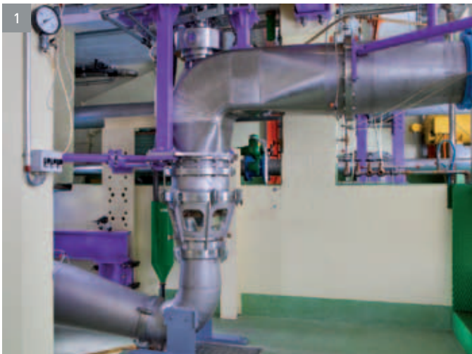
1 Modèle réduit de la turbine Diagonale à 8 pales montée sur le stand d'essai Mhylab.
